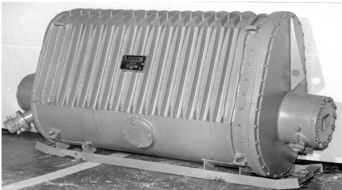
Рисунок 2 – Общий вид взрывозащищенного трансформатора типа 2ТСВ-630/6
