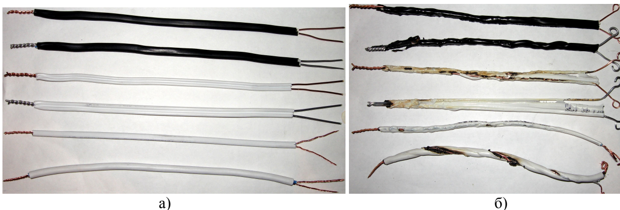
Рисунок 2 – Внешний вид кабельных изделий, на фото сверху вниз представлены ВВГ 2x1,5; АВВГ 2x2,5; ППВ 2x1,5; АППВ 2x2,5; ШВВП 2x0,75; ПВС 2x0,75: (а) до проведения эксперимента; (б) после проведения эксперимента,
